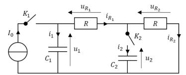
Le circuit étant au repos (toutes les grandeurs nulles pour t<0), on ferme l'interrupteur  $K_1$  en t=0. Le générateur idéal de courant impose alors  $I_0=cte$  dans sa branche pour tout  $t\geq 0$ . On rappelle que la tension la tension aux bornes d'un générateur de courant peut prendre n'importe quelle valeur dans  $\mathbb{R}$ .
